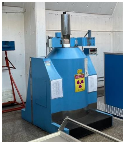
Figura 4. Irradiador Gammacell 220-R de Cobalto ( \text{Co}^{60} ). Se muestra una foto del irradiador utilizado en esta investigación, el cual se encuentra en Comisión Chilena de Energía Nuclear. Fuente propia.
