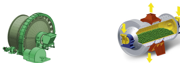
FIGURA 2.7: Molinos SAG [4] y molino tradicional [5]
