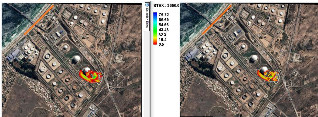
Figura 32: Capa 7 de la modelación sin tratamiento (izquierda) y con tratamiento (derecha) a los 3.650 días. Se destacan los BTEX en mg/l con su respectiva escala de colores.
