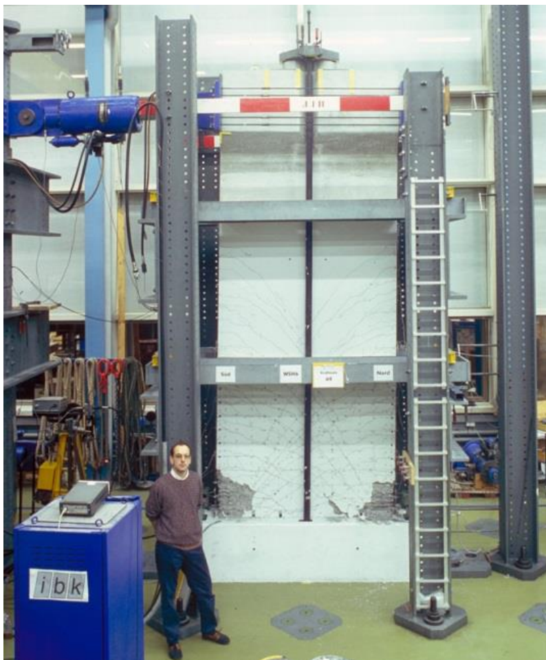
Figura 4.13 – Configuración de los ensayos de Dazio et al. [12].
