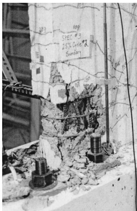
Figura 4.8 – Inestabilidad lateral, pandeo fuera de plano RW2. [19]
